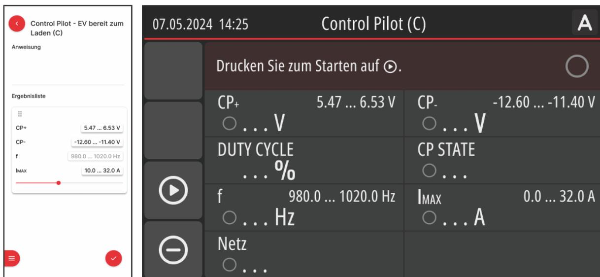
Abbildung 35: Control Pilot - EV bereit zum Laden (C) "MiControl"-Anwendung und Messbildschirm
