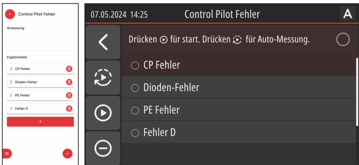
Abbildung 40: Control Pilot Fehler "MiControl" Anwendung und Messbildschirm
