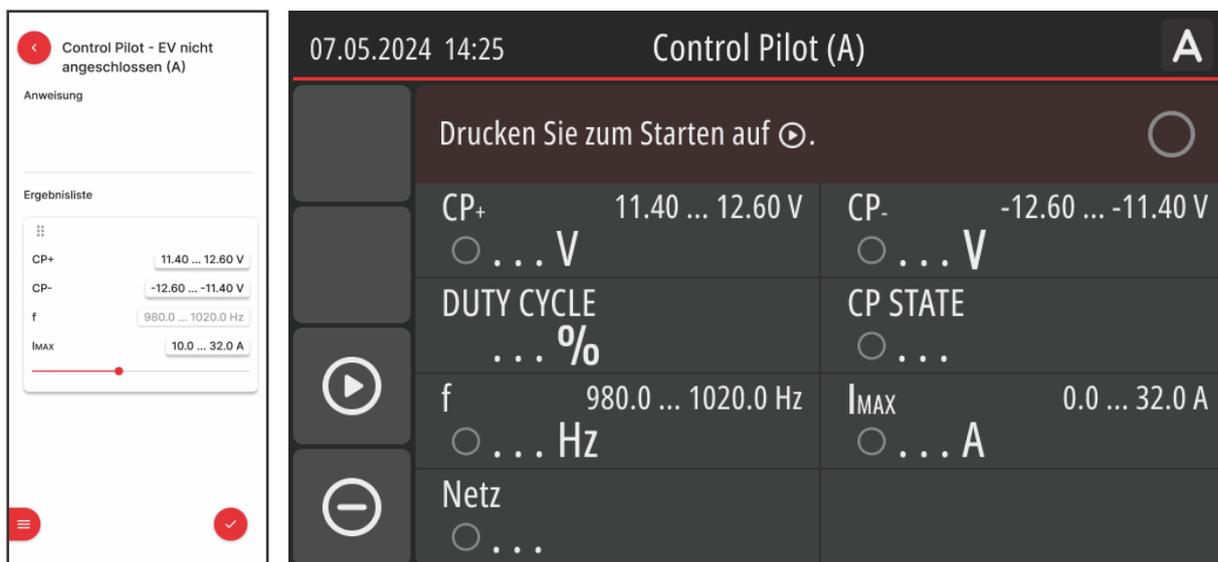
Abbildung 33: Control Pilot - EV nicht angeschlossen (A) "MiControl"-Anwendung und Messbildschirm
