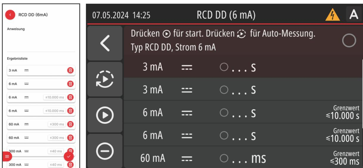
Abbildung 27: RDC DD "MiControl" Anwendung und Messbildschirm
