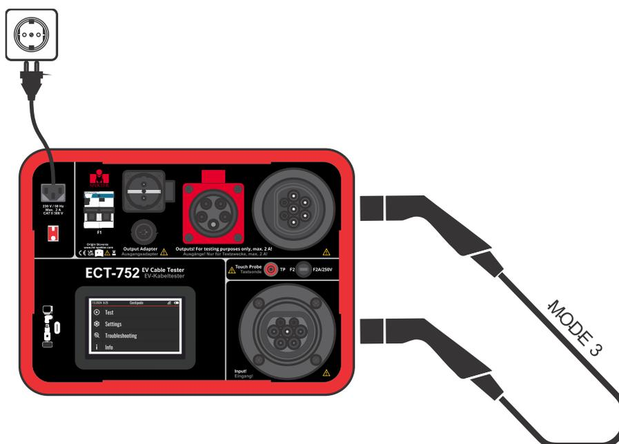
Abbildung 45: Anschluss des ECT-752 an das Netz und des Modus 3 Kabels an ECT-752
