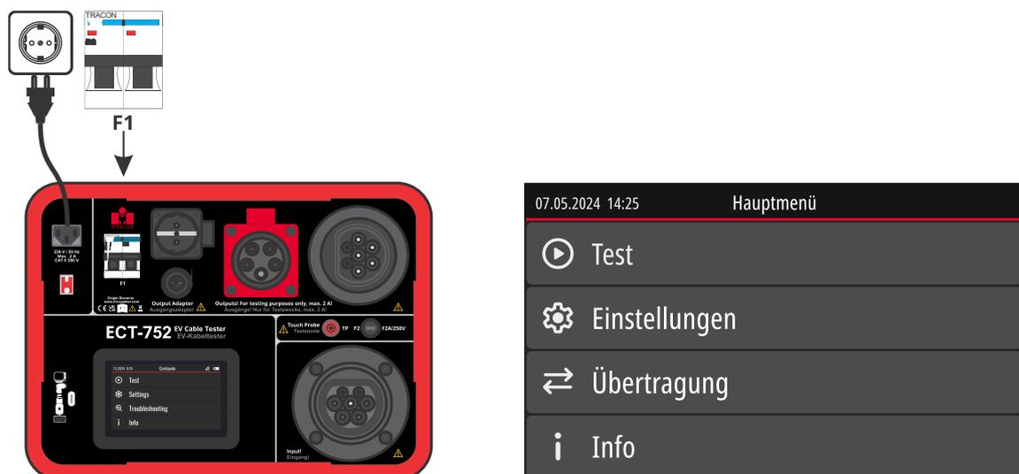
Abbildung 3: Anschluss des Testers an das Netz und Anzeige des Hauptmenüs
