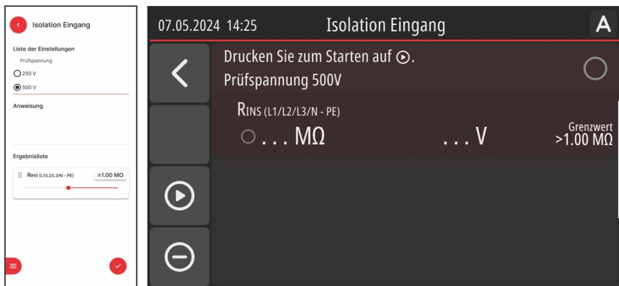
Abbildung 21: R<sub>INS</sub> Input "MiControl" Anwendung und Messbildschirm
