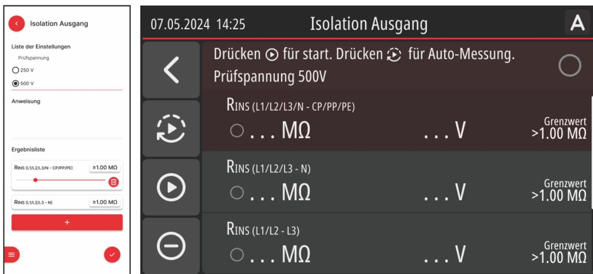
Abbildung 23:  $R_{INS}$ -Ausgang "MiControl"-Anwendung und Messbildschirm
