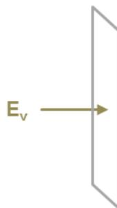
**i** Für den Arbeitsbereich „Lesetätigkeit an Schrank- und Regalflächen“ wird die vertikale Beleuchtungsstärke auf einer Höhe von 0,5 m bis 2,00 m gemessen. Die mittlere vertikale Beleuchtungsstärke  $E_v$  sollte dabei mindestens 175 Lux betragen. Werden solche Tätigkeiten häufig und längere Zeit durchgeführt, wie z.B. in Bibliotheken oder Archiven, sollte die mittlere vertikale Beleuchtungsstärke  $E_v$  mindestens 300 Lux betragen.
