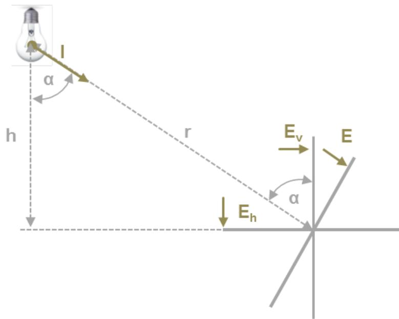
Ist die beleuchtete Fläche seitlich versetzt zur Lichtquelle, d.h. trifft der Strahl nicht senkrecht auf die Fläche auf, dann verringert sich die Beleuchtungsstärke. Wenn sich die Lichtquelle in der Höhe  $h$  über der horizontalen Ebene befindet und der Ausstrahlungswinkel  $\alpha$  bezogen auf die Senkrechte ist, dann errechnet sich die horizontale Beleuchtungsstärke  $E_h$  und die vertikale Beleuchtungsstärke  $E_v$  zu
