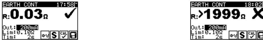
Abbildung 5.7: Beispiele von Messergebnissen für den Erddurchgangswiderstand
