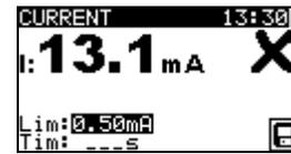
**Abbildung 5.45:** Beispiel für das Ergebnis einer Zangenstrommessung
