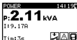
Abbildung 5.40: Beispiel für das Ergebnis einer Scheinleistungsmessung
