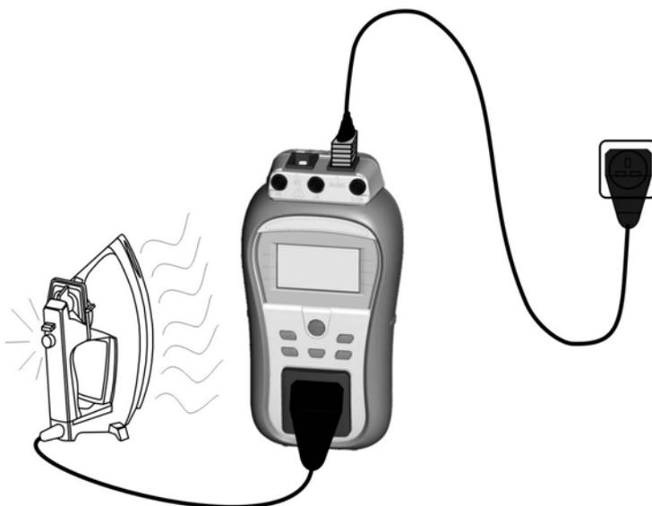
Abbildung 5.39: Leistungsprüfung
