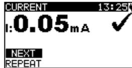
**Abbildung 6.48:** Ergebnisbildschirm für die Zangenstrom-Messung
