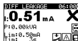
Abbildung 5.29: Beispiel für das Ergebnis einer Differential-Leckstrommessung
