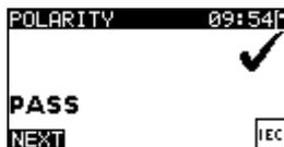
**Abbildung 6.44:** Ergebnisbildschirm der Polaritätsprüfung
