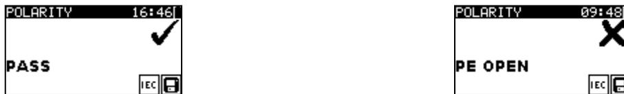
Abbildung 5.26: Beispiel eines Polaritätsprüfungsergebnisses
