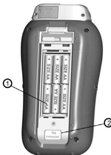
**Abbildung 2.4: Batteriefach**
