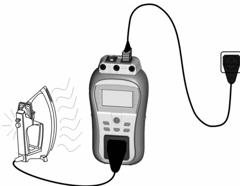
Abbildung 5.28: Messung des Differential-Leckstroms
