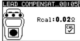
Abbildung 4.14: Bildschirm für die Leitungskompensation
